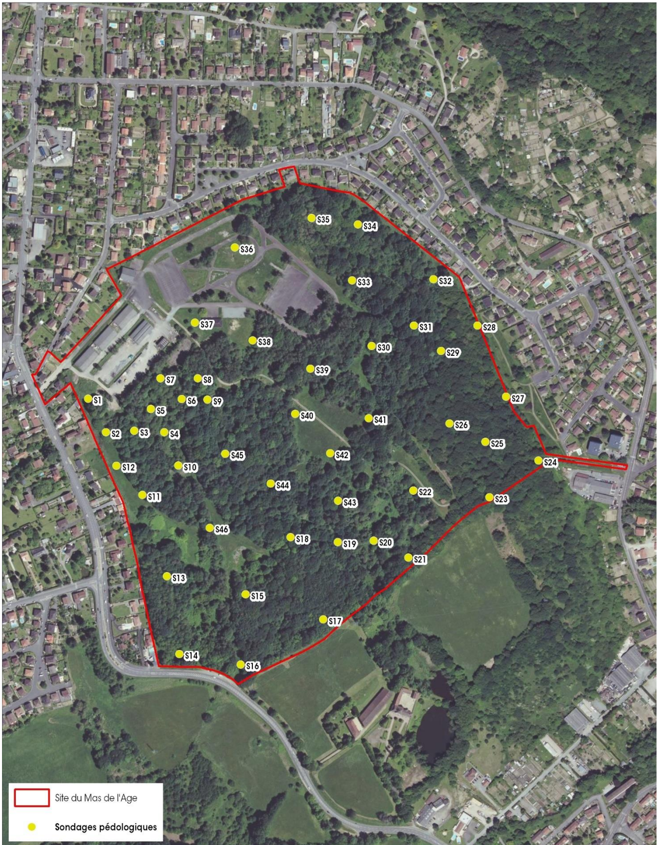
Figure 58 : Localisation des sondages pédologiques pour la délimitation des zones humides
