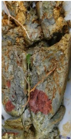
Horizon réductique mis en évidence par l'ortho- phénanthroline
